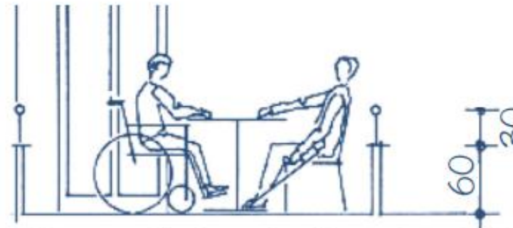
Brüstungen für den rollstuhlgerechten Freisitz
