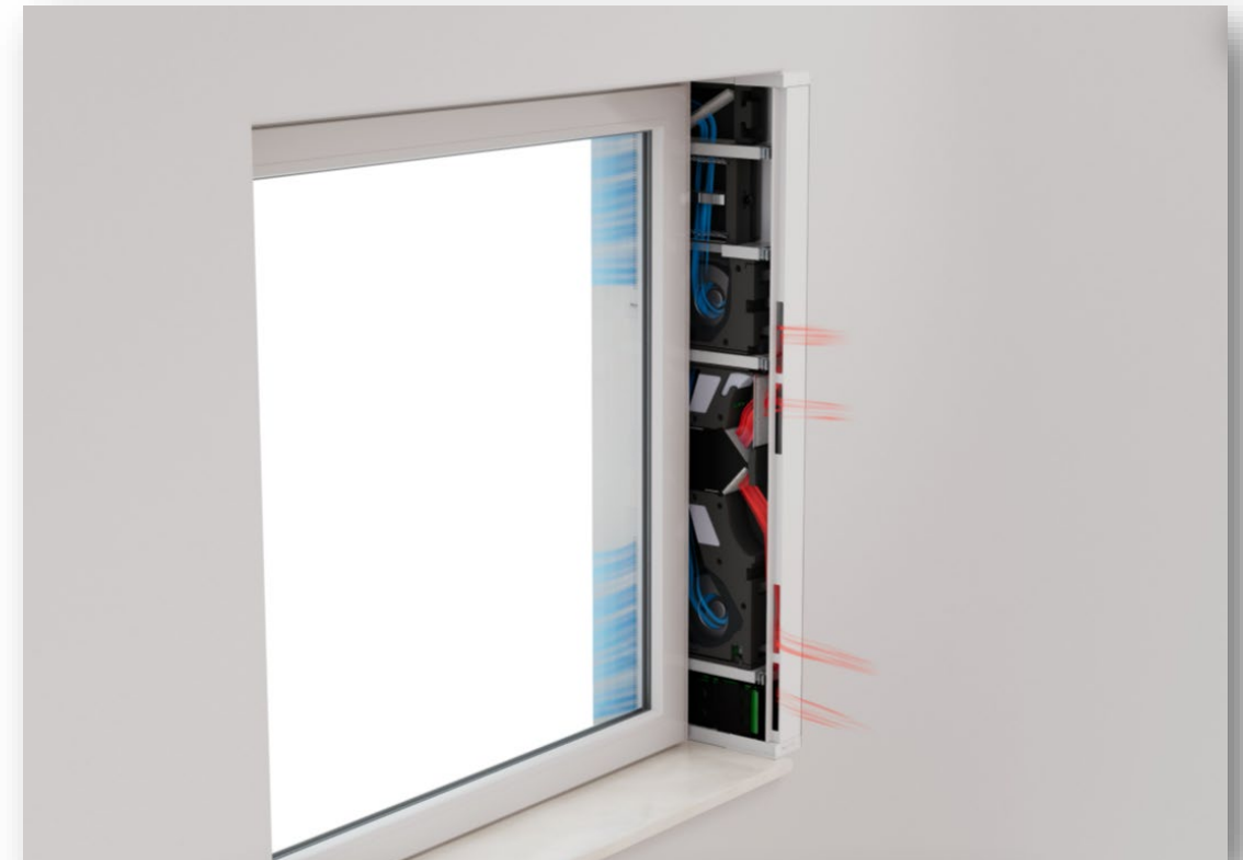
Einbau in der Fensterlaibung
