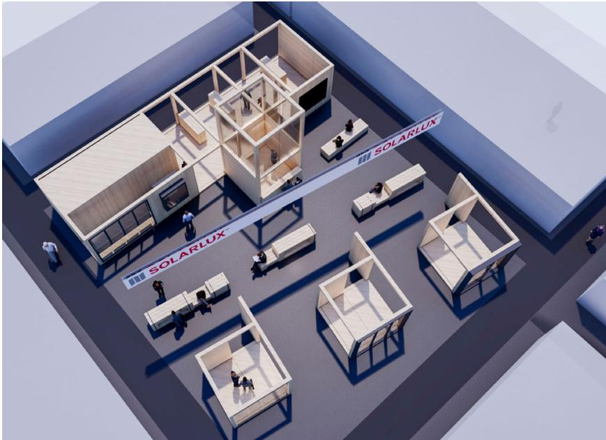
**Solarlux\_Messestand\_BAU2023\_02.jpg (Grafik: Solarlux):** Der Solarlux Messestand setzt sich aus wiederverwertbaren 3 x 3 x 3 m großen, unbehandelten Brettschichthölzern zusammen, die auf einer Zero-Waste-Philosophie basieren.
